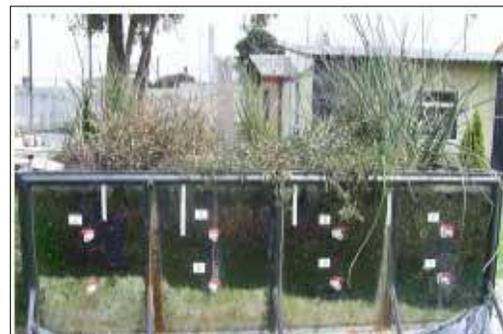
**Figura 25. Humedal Optimizado diferentes profundidades del lecho. En la entrada Barbascos del pantano, en la zona del centro se encuentra el Botoncillo y a la salida está el Junco.**
