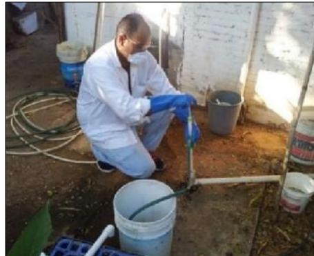
Figura 52. Extracción de muestra (C) agua residual (afluente).
