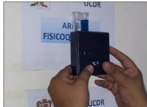
**Figura 58. Determinación de Sulfuro de Hidrogeno Método colorimétrico Hach.**
