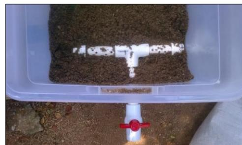
Figuras 42-43. Detalle de drenaje de salida siguiendo especificaciones EPA (1999).
