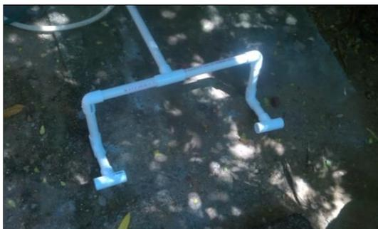
Figura 45. Detalle de tubería para alimentación de humedales.
