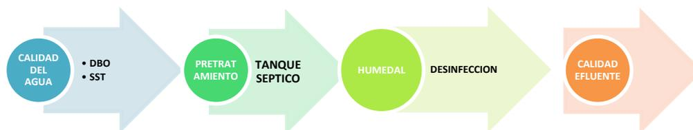
Figura 31. Diagrama de bloques del sistema de tratamiento.
