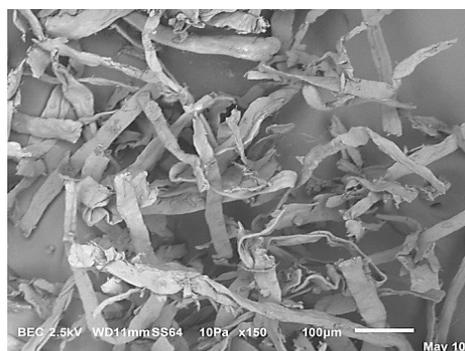
Figura 2. Fibras de microcelulosa a partir de bagazo de caña
