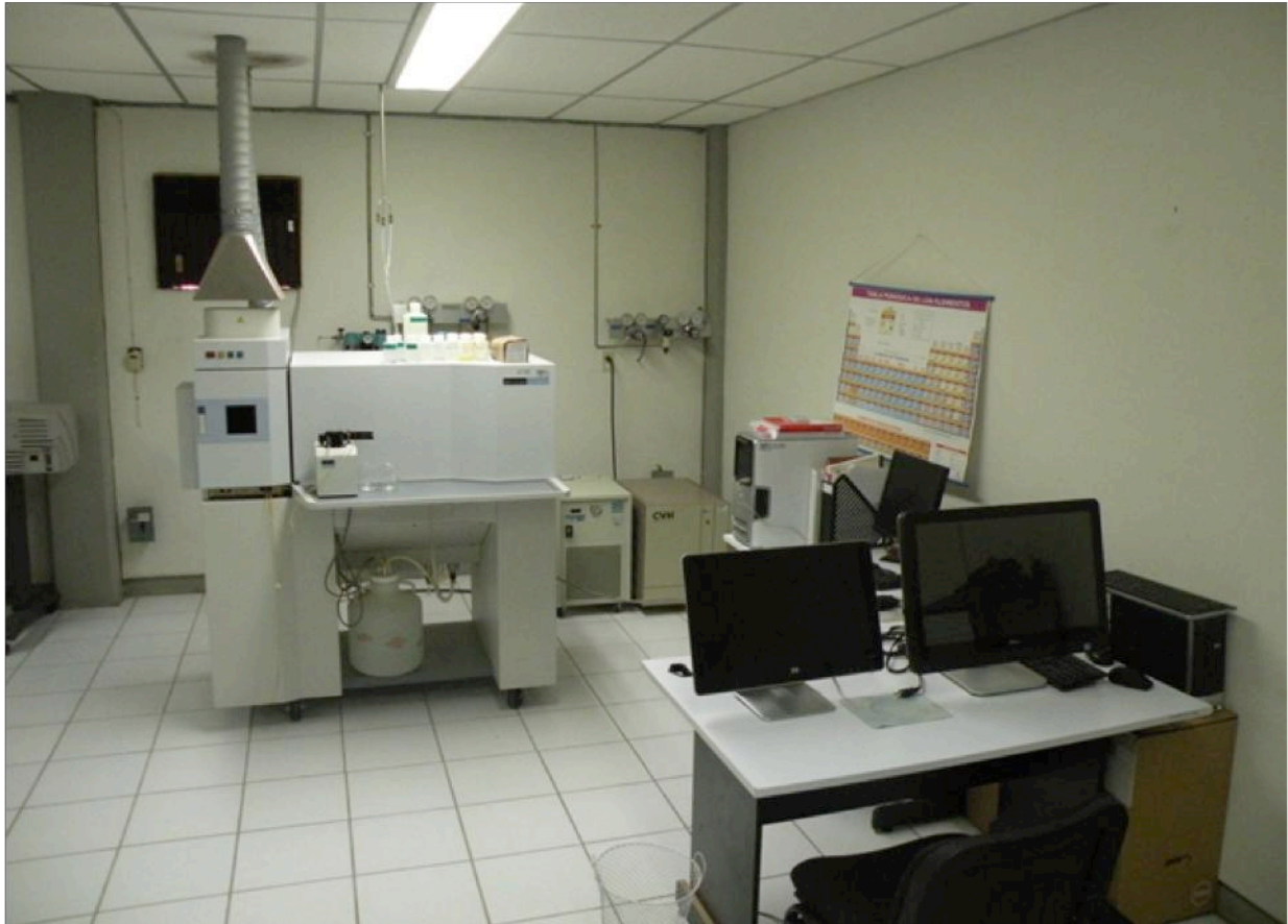
Figura 5. Espectroscopio de plasma por acoplamiento inductivo (ICP-AES), con el cual se realizaron los análisis geoquímicos a las plantas de jitomate. El equipo está localizado en el Laboratorio de Geoquímica de la Escuela Superior de Ciencias de la Tierra, de la Universidad Autónoma de Guerrero.
