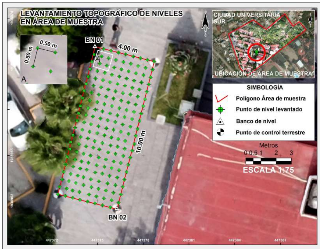
Figura 32. Levantamiento altimétrico en la zona de prueba dentro del área de estudio.
