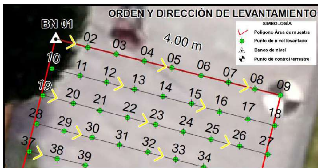
Figura 33 Orden y dirección de levantamiento topográfico.
