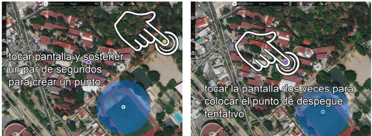
Figura 7 a) Para crear vértices de polígono de misión de vuelo. b) Creando ubicación tentativa de despegue y aterrizaje, Punto de Inicio Móvil marcado en azul.
