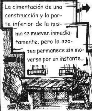
La cimentación de una construcción y la parte inferior de la misma se mueven inmediatamente, pero la azotea permanece sin moverse por un instante...
