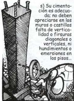
s) Su cimentación es adecuada; no deben apreciarse en los muros o castillos falta de verticalidad o fisuras diagonales o verticales, ni hundimientos o emersiones en los pisos...
