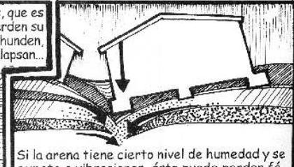
Si la arena tiene cierto nivel de humedad y se somete a vibraciones, ésta puede perder fácilmente su resistencia y comportarse como si fuera un líquido.
