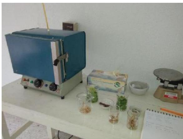
Fig. 59 Secado en mufla a 60° C
