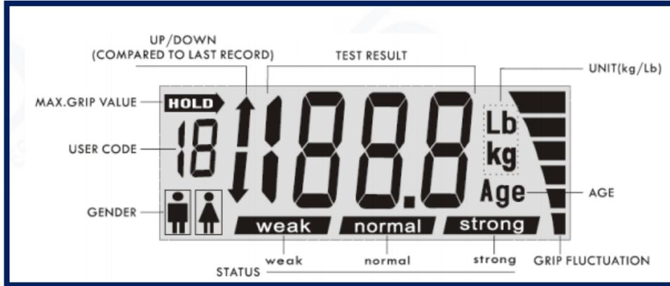
Figura 3. 16 Configuración dinamómetro (Manual de usuario dinamómetro CAMRY EH101).
