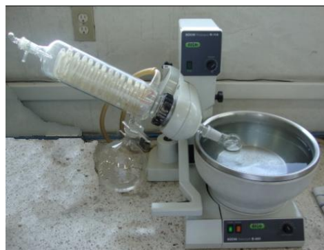
b) Recuperación de la grasa por evaporación del hexano
