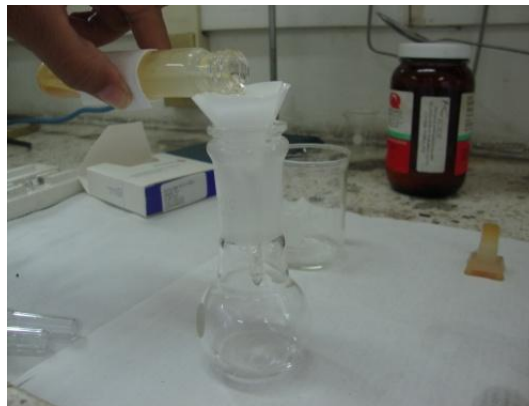
d) Limpieza de extracto con sulfato de sodio
