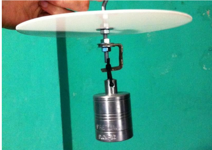
Imagen 7. Disco de Secchi utilizado; de color blanco y plomada de 3lb.
