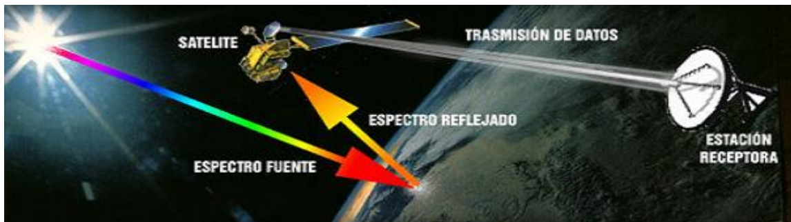
Figura 5. Esquema general de las funciones de la percepción remota o teledetección. Tomado de Martínez-Muñoz y Díaz Ponce, (2005).
