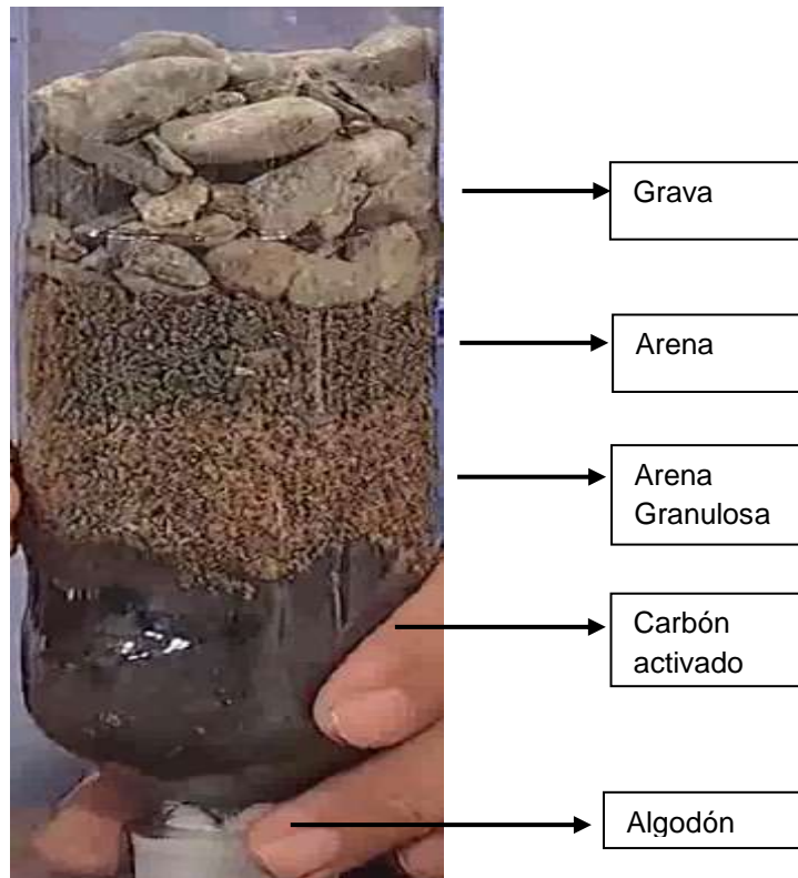
Imagen 8.- Filtro casero con un bote de plástico donde se coloca el algodón, carbón arena, y grava
