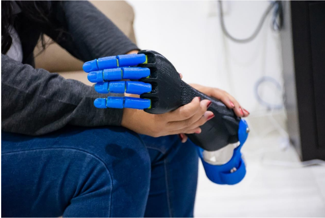
Imagen 16. Prótesis elaborada con tecnología en impresión 3D
